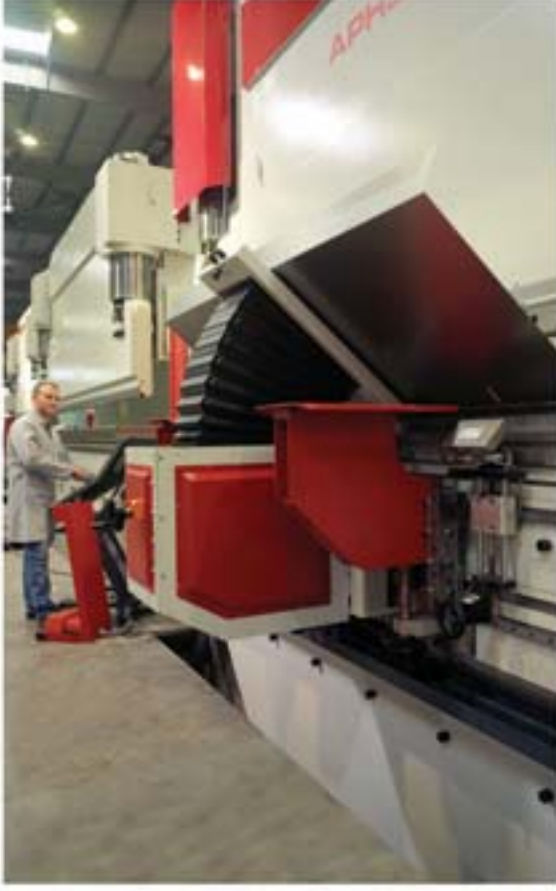
Kolay açılır kalıp tutma sistemi Quick release clamps
