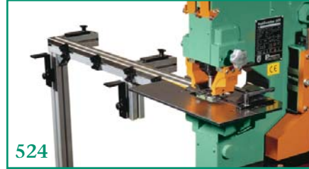
Linear gauge rail 39", 78", 118" (1m, 2m, 3m)
